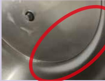
エアディスペーサの角度変更やアトマイザーディスクの形状変更をすることで、液滴の噴射角度を下げて、塔壁までの距離を伸ばし、乾燥時間を稼ぐことで塔内の粉体付着を低減します。
