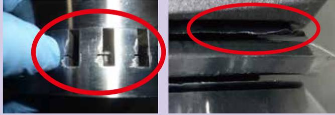
スラリーとの接液部分には、**ダイヤモンドコーティング**や**高密度ポリエチレン**など、スラリー原料に併せて**耐摩耗性**の部品を使うことで、摩耗を防ぎます。
